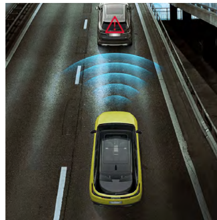
System ostrzegający przed kolizją czołową LCW oraz system automatycznego hamowania awaryjnego AEB (wersja LUXURY)
