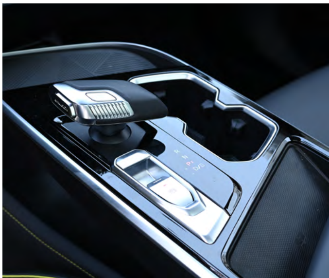
Elektroniczne sterowanie zautomatyzowaną skrzynią biegów 7DCT
