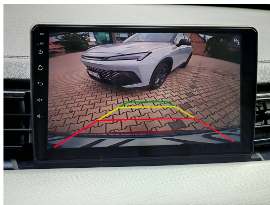
Kamera cofania z dynamicznymi liniami pomocniczymi
