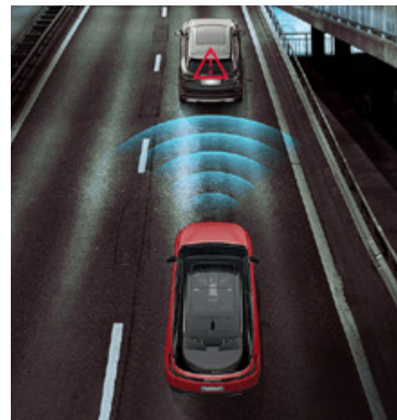
System ostrzegający przed kolizją czołową LCW oraz system automatycznego hamowania awaryjnego AEB
