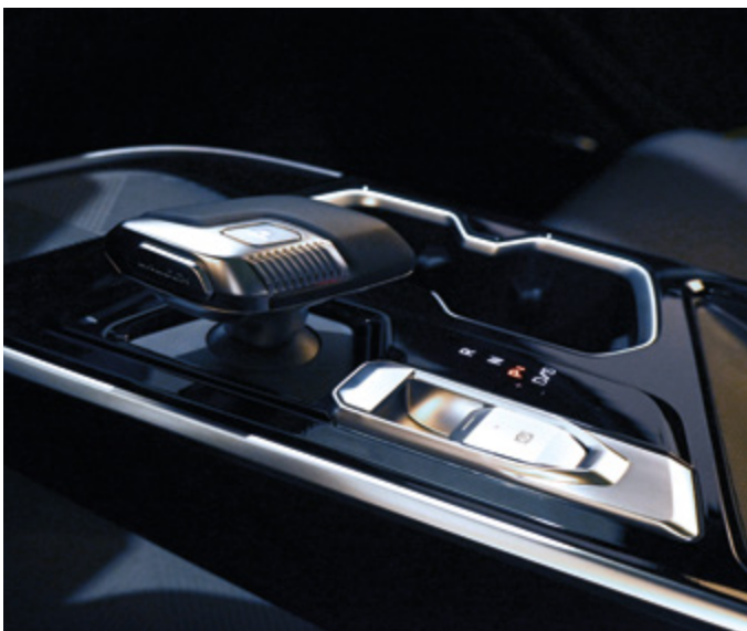
Elektroniczne sterowanie zautomatyzowaną skrzynią biegów 7DCT
